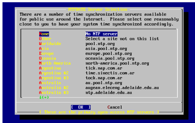
Ábra 2-58. Az Ntpdate beállítása
